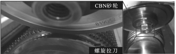
图 6 螺旋内齿圈拉刀刃磨状态
